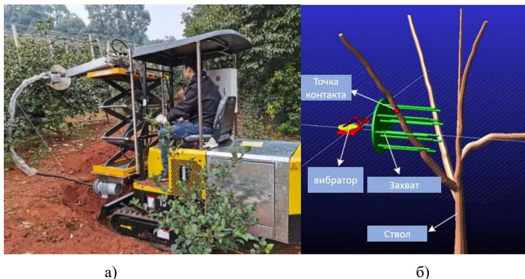
Рисунок 1.2 - Системы для сбора плодов камелии; а) общий вид системы; б) 3D изображения захватного устройства и вибратора.
