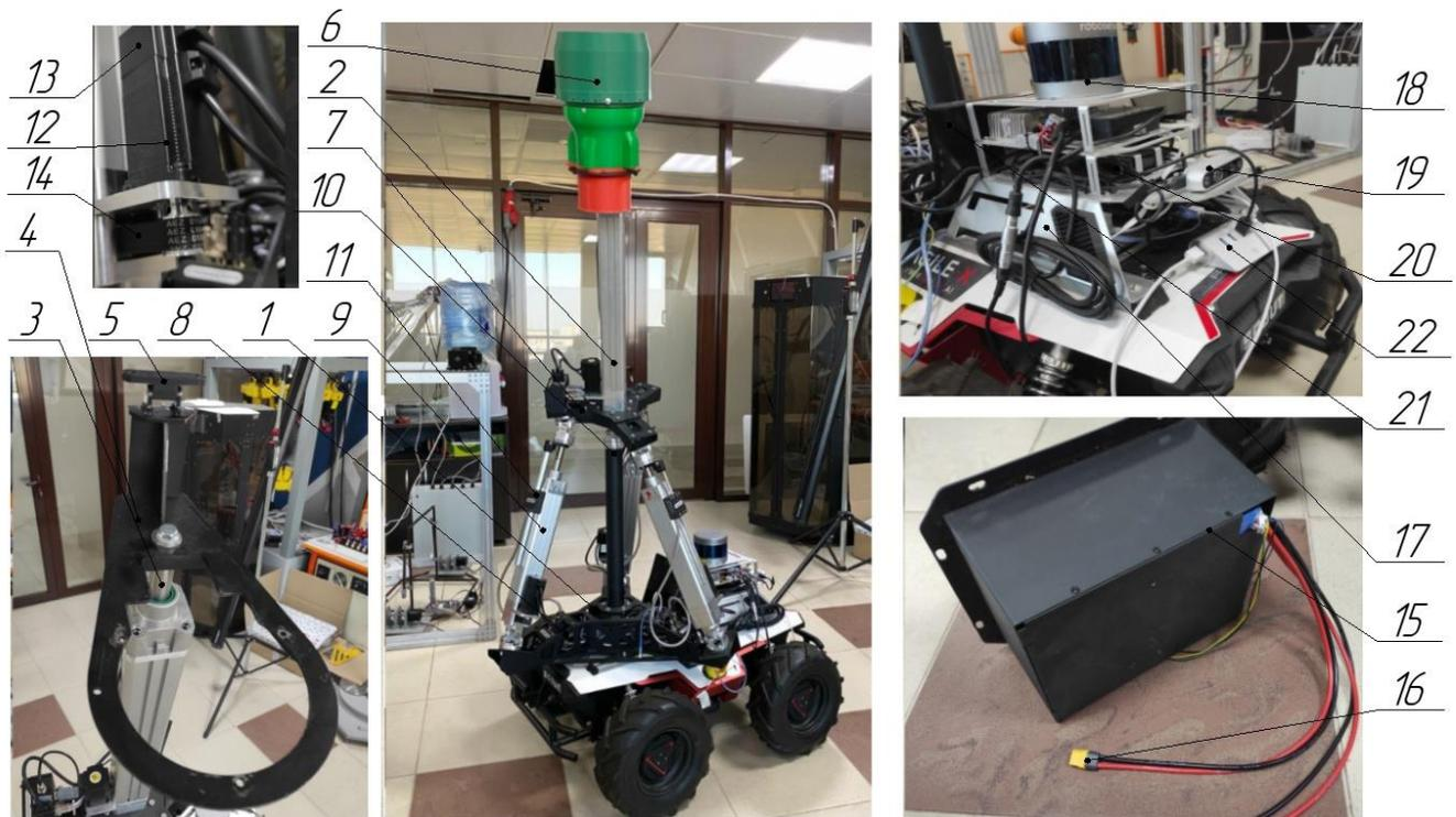
Рисунок 4.12 - Экспериментальный образец автономной РТС для сбора фруктов.
