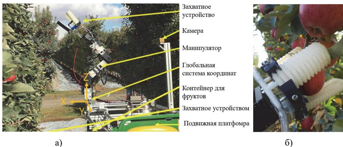
Рисунок 1.4 - Системы для сбора яблок; а) общий вид системы; б) захватное устройство
