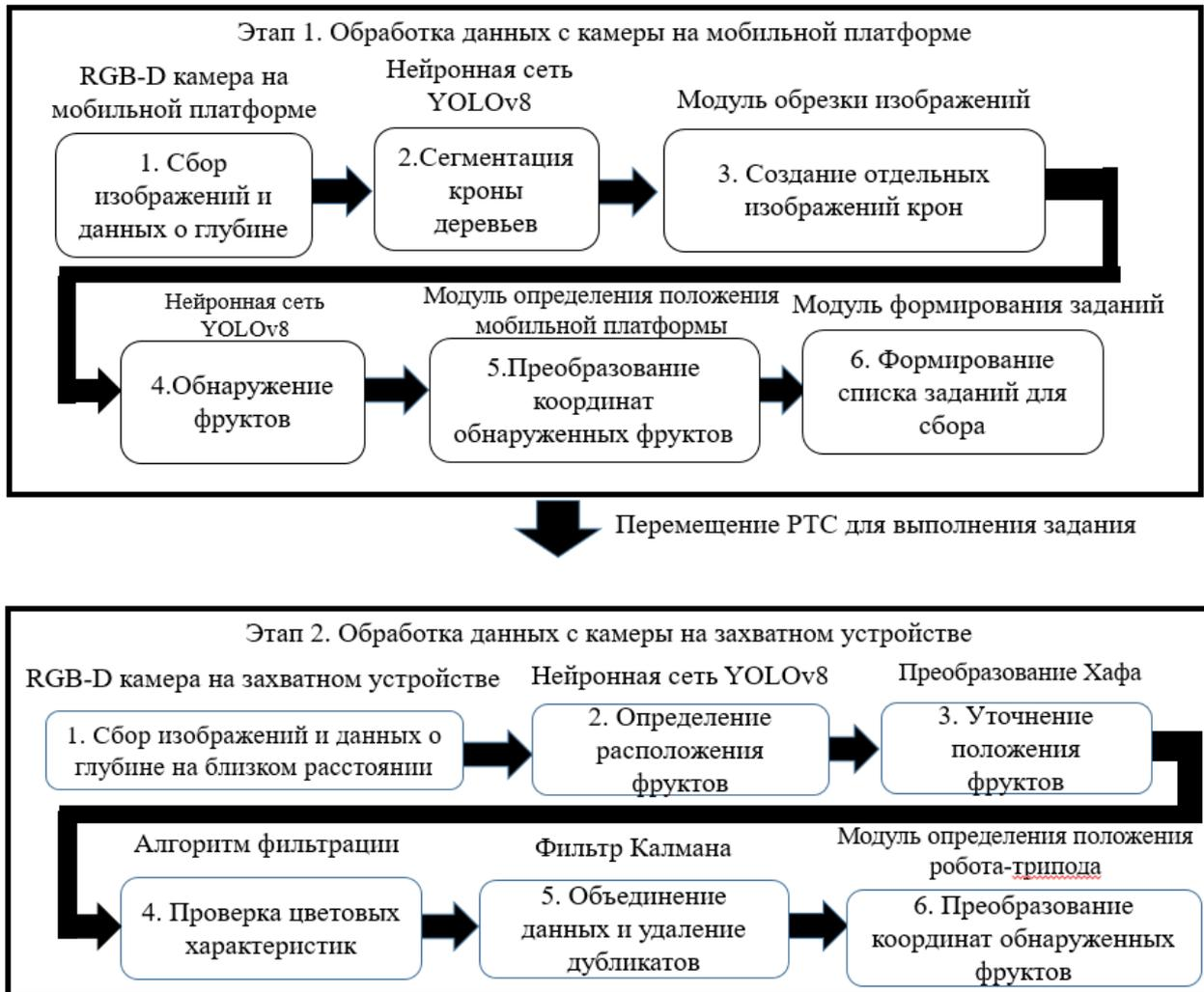
Рисунок 2.8 – Алгоритм технического зрения.
