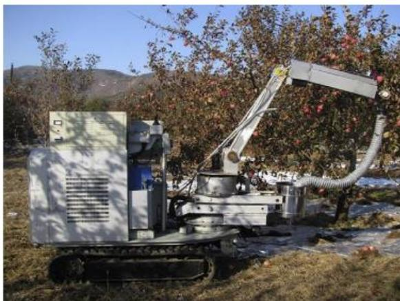
Рисунок 1.7 - Робот для сбора яблок на гусеничной основе
