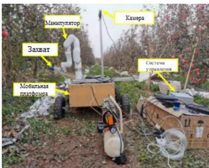
Рисунок 1.9 - Малоразмерный РТС для сбора яблок с мягким захватом
